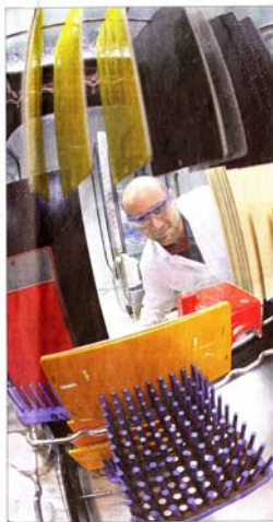
Wie verhalten sich die Yachtlacke in feuchter Umgebung? Das prüft Heiko Bandholz in einer Klimakammer. Dort lagern die Testobjekte 2000 bis 3000 Stunden (Foto links). Peter Witte von der Geschäftsführung der Firma Mankiewicz ist auch für das Forschungslabor zuständig. (FOTOS: HILLMER)
